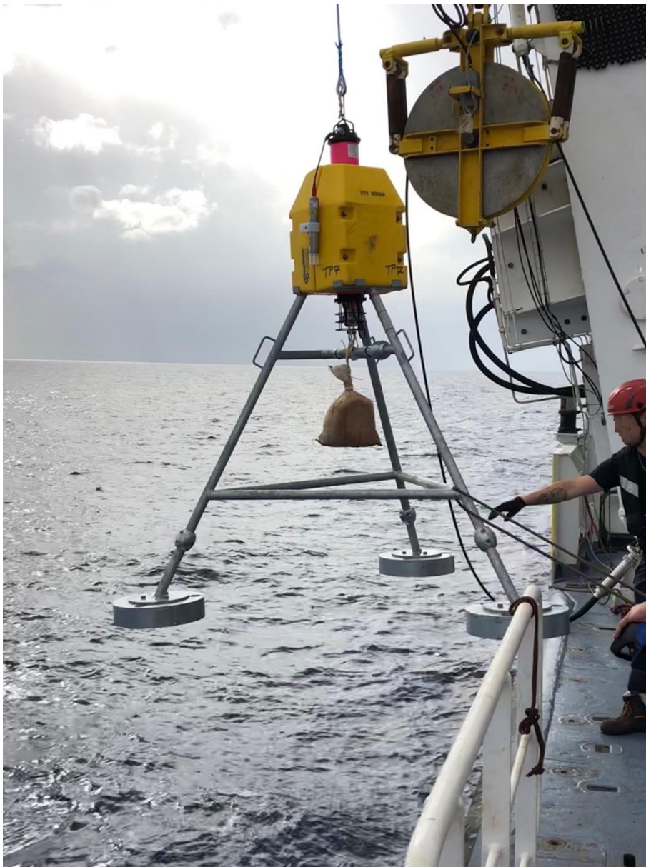
Mise à l'eau d'une station géodésique fond de mer (balise acoustique Canopus) au large de Catane depuis le navire Pourquoi Pas ? au cours de la campagne FocusX1 en octobre 2020.
