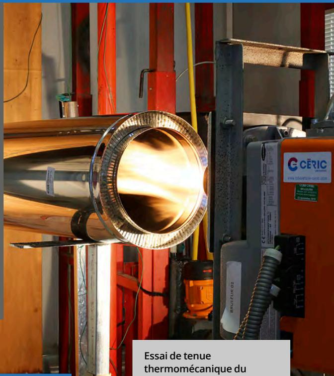
Essai de tenue thermomécanique du conduit de cheminée en sollicitation extrême au feu.
