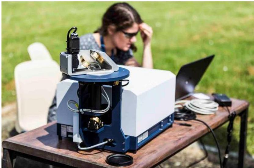
**Déploiement d'un spectromètre EM27/sun sur le site d'Aire sur l'Adour le 24 mai 2018.** Cet instrument mesure les quantités de gaz à effet de serre sur toute une « colonne » d'atmosphère.
