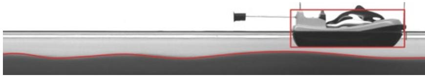
Vue latérale de l'expérience d'eaux-mortes en laboratoire pour une force de traction donnée © Pprime (CNRS)
