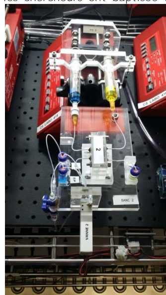
Banc instrumenté de microfluidique, actuellement opérationnel à Singapour au laboratoire CEA/NTU SCARCE permettant de réduire à 1ml une expérience d'extraction sélective de métaux @CEA/ICSM
