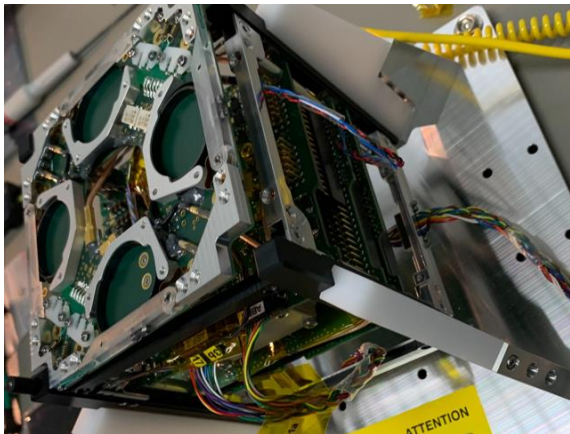
Figure 1: Nano-satellite UVSQSAT en cours d'intégration. Crédits : ISIS/UVSQ.
