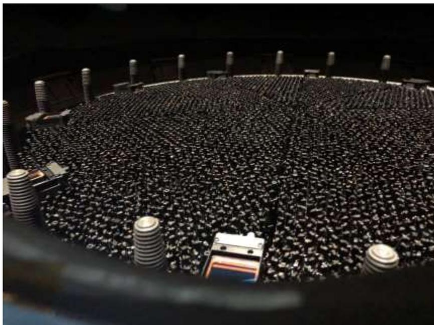
*Equipé de 5000 petits robots disposant chacun d'une fibre optique, Desi est en mesure de pointer automatiquement vers une liste précise de galaxies et de quasars préalablement sélectionnés pour en détecter la lumière et ainsi mesurer leur distance à la Terre. © LBL*
