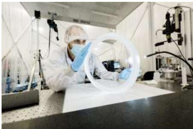
Inspection d'une lentille avant intégration dans un des spectrographes © Winlight
