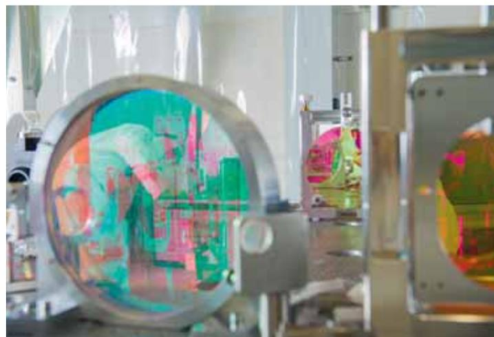
Éléments d'un banc optique du détecteur d'ondes gravitationnelles Virgo, en salle blanche. Il permettra d'observer le faisceau qui arrive à l'extrémité d'un bras de l'interféromètre.
