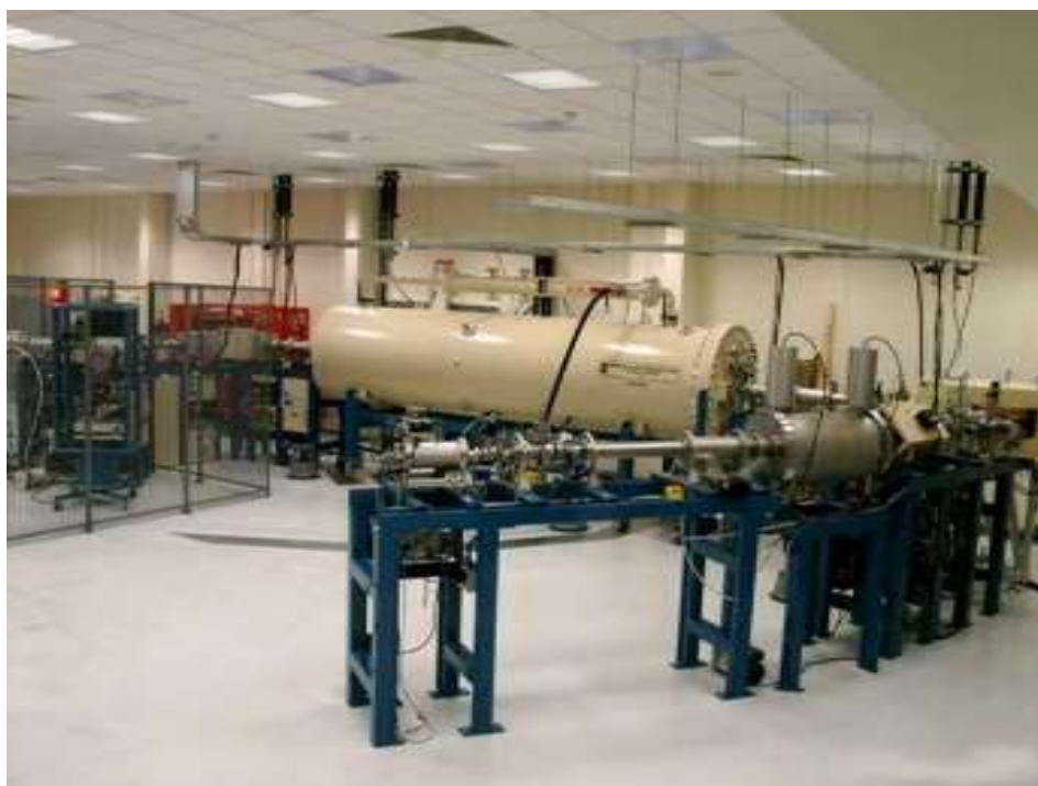
Spectromètre de masse par accélérateur (SMA) Artemis utilisé pour mesurer la proportion de ^{14}\text{C} dans des échantillons de carbone. Inauguré en 2004, il permet d'analyser environ 4000 échantillons par an © LSCE/IPSL
