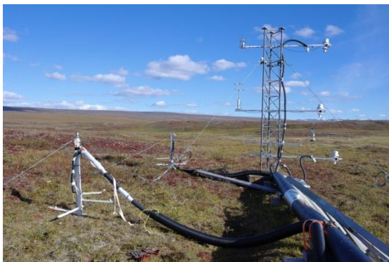
Tour à flux mesurant les échanges de mercure dans la toundra à Toolik Field Station en Alaska.
