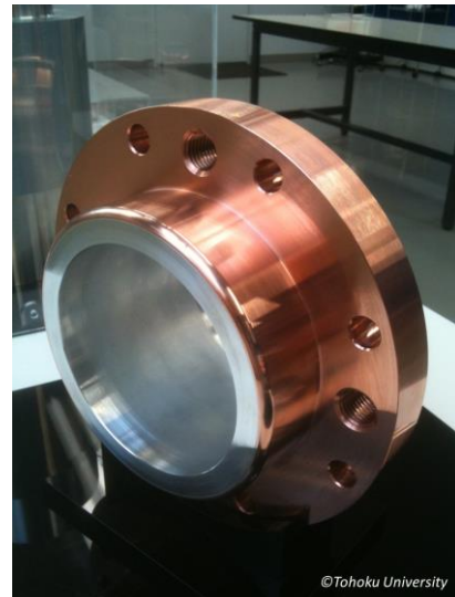
Épais dépôt de cuivre (sur 50 à 60 mm) obtenu par « Cold spray ». Le cuivre déposé est usinable : trous de vis, bride, etc. © Tohoku University
