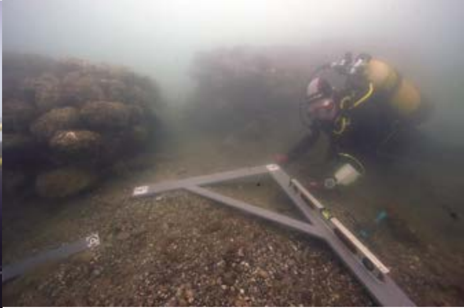
Figure 3 : Levé topographique préparatoire au relevé par photogrammétrie rapprochée des structures architecturales de l'Anse de Saint-Gervais, chantier-école de Fos-sur-Mer. © Loïc Damelet, Centre Camille Jullian
